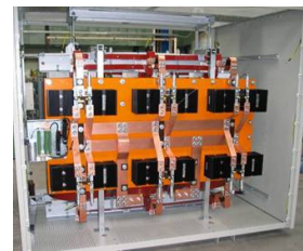
Transformator kompaktowy z prostownikiem do zasilania tracji tramwajowej na napięcie 15kV o mocy 1200kVA.
