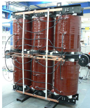
Transformator 24-pulsowy do zasilania przetwornicy częstotliwości 50/60Hz o mocy 1600kVA na napięcie sieci 15kV
