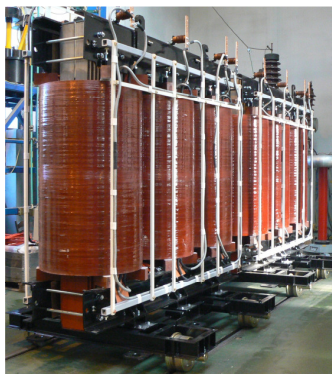
Transformatory 8000kVA o przekładni 20/6kV
